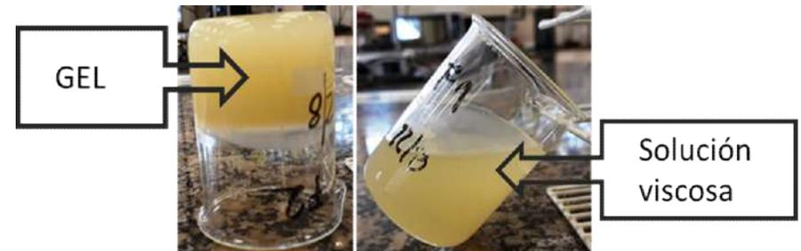
Figura 1. Apariencia visual de las mezclas SFO/BW; izq.: 2 % de BW, der.: 1 % de BW.
