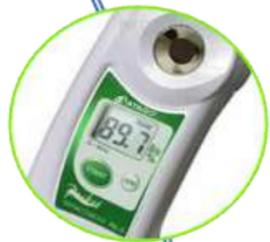
Los grados Brix se miden con un **Refractómetro (manual o digital)**.
